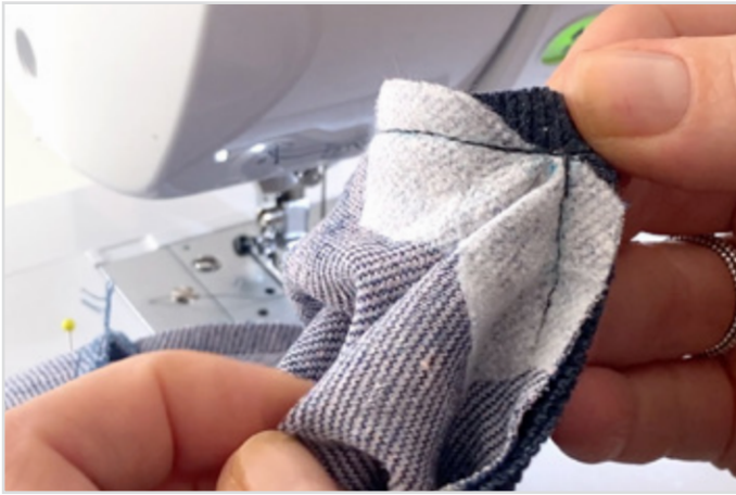
Fertig angenähtes Bündchen. Hier treffen sich beide Teilnähte in der vorderen Mitte bzw. beim V.
