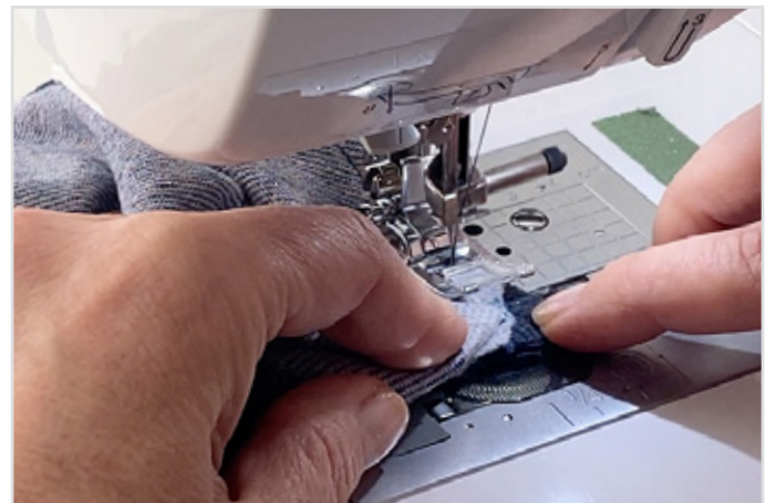
An der hinteren Mitte beginnend nun bis zur V-Ausschnitt-Spitze nähen. Die jetzige Naht trifft dabei exakt auf das Ende der ersten Naht.
